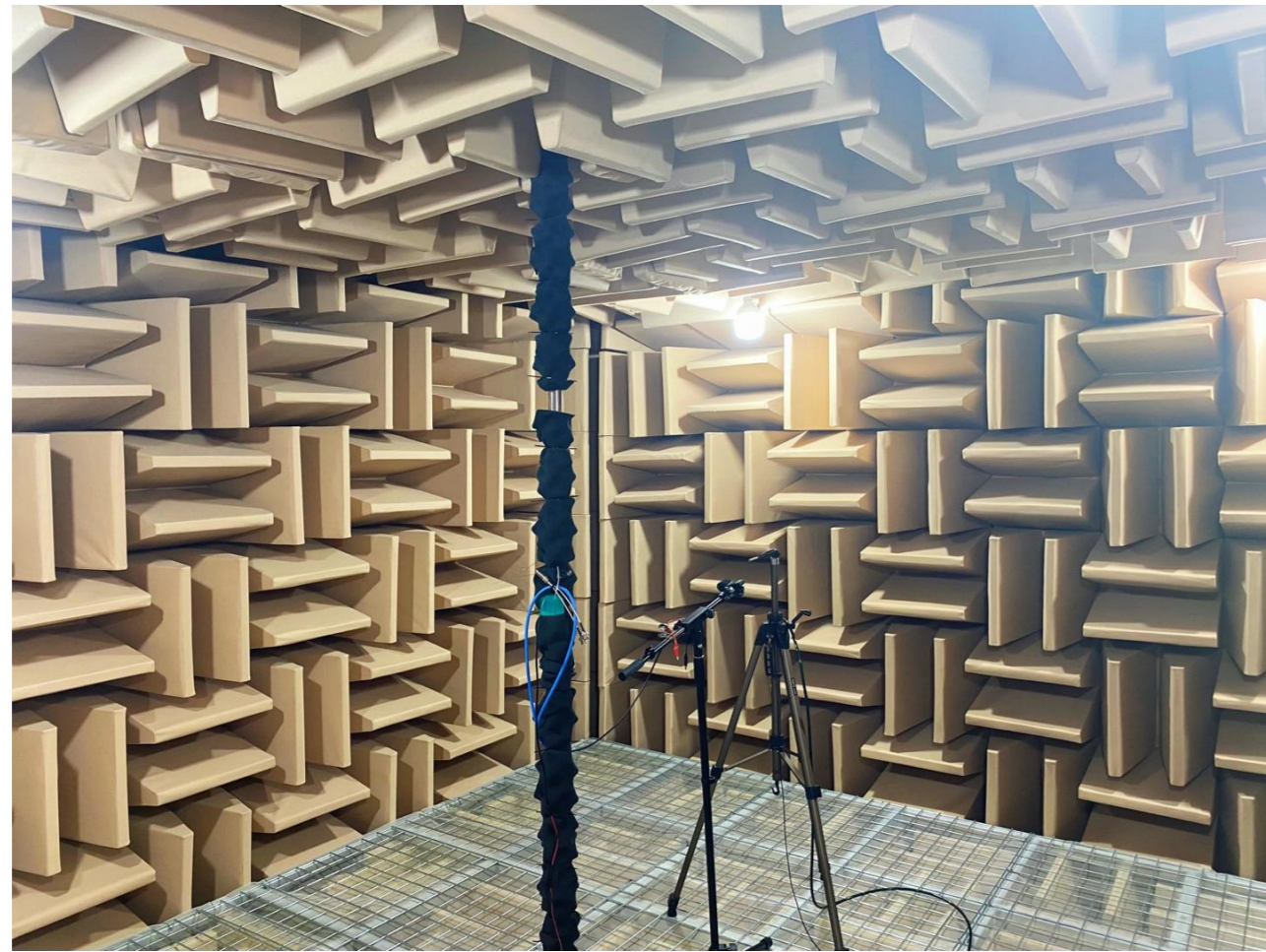
Anechoic chamber – SELTECH China
